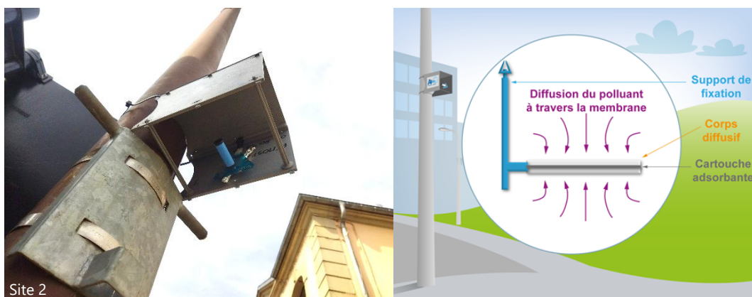
Figure 1 : principe des prélèvements passifs par tubes Radiello©
